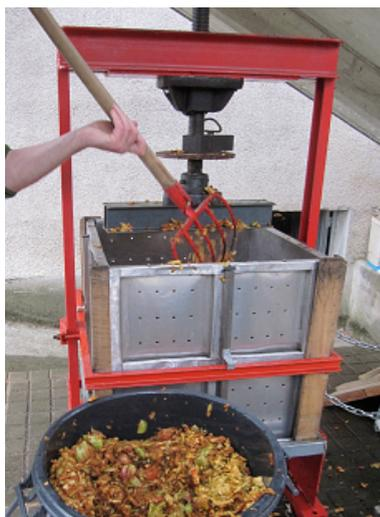
Figura 2: Prensado de la manzana con una prensa manual.
