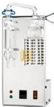
Figura 5: Volatímetro eléctrico de la casa GAB.
